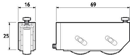
KRYPTOS carrello inferiore regolabile completo di viti di fissaggio
